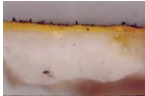
La foto mette in evidenza lo strato pittorico a base di ocra gialla che caratterizza il campione in studio. Sezione Lucida, Luce riflessa, 200 X, N//
