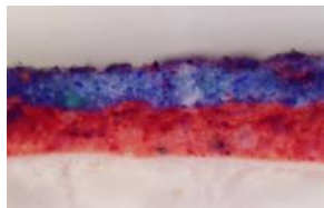
Foto del campione in studio dove si osserva lo stato d'imprimitura rosso a base di calce e pigmenti ocreaci su cui insiste la pennellata blu a base di
