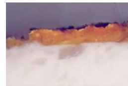
La foto riprende la situazione stratigrafica del campione in studio caratterizzata da una doratura applicata su una missione oleoresinosa pigmentata. Sezione Lucida, Luce riflessa, 200 X, N//
